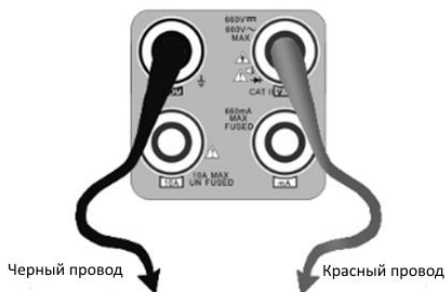
Рис.3.1-1 Подключение измерительного щупа к тестеру.
