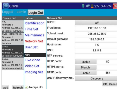
Рис.3.3.3-6 Сетевые установки (настройки IP протокола)
