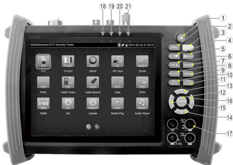
Рис. 2 Элементы экранного интерфейса и органы управления тестеров TIP, TIP-L-M, TIP-L-MT, TIP-M, TIP-MT, TIP-O-M
