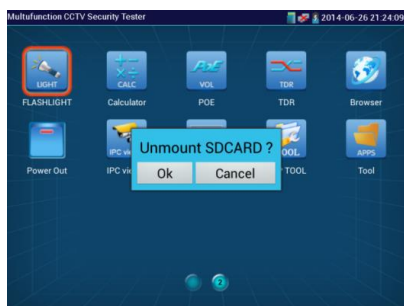
Рис. 3.3-2 Приглашение демонтировать флеш-карту
