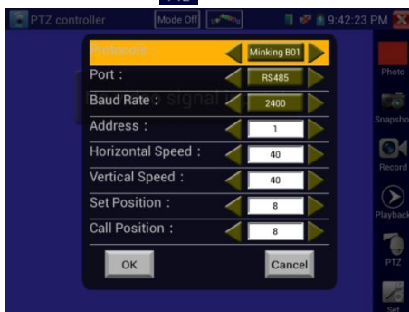
Рис.3.3.1-2 Окно настройки протокола управления камерой (RS485)
