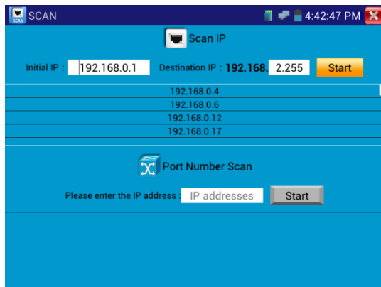
Рис.3.3.6-1 Окно сканирования IP-адресов
