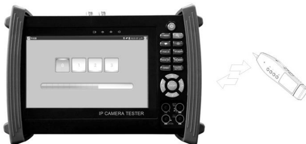
Рис.3.3.9-2 Схема поиска (трассировки) кабеля.
