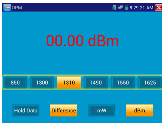
Рис. 3.3.12-1 Измерение относительной оптической мощности
